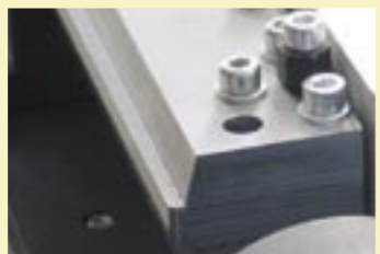
Auftragskopf mit plan geschliffener Breitschlitz- düse für kontinuierlichen Flächenauftrag
