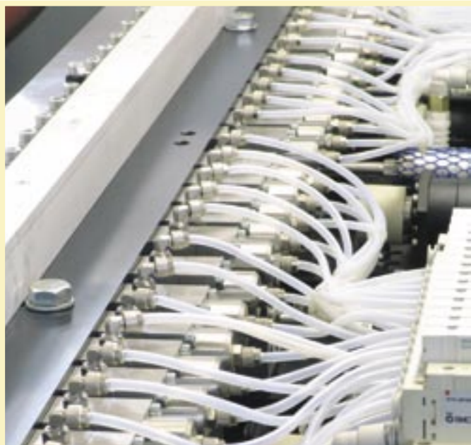
Pneumatisch geschaltete Einsteckmodule ermöglichen schnelle Verstellung der Auftragsbreite.
