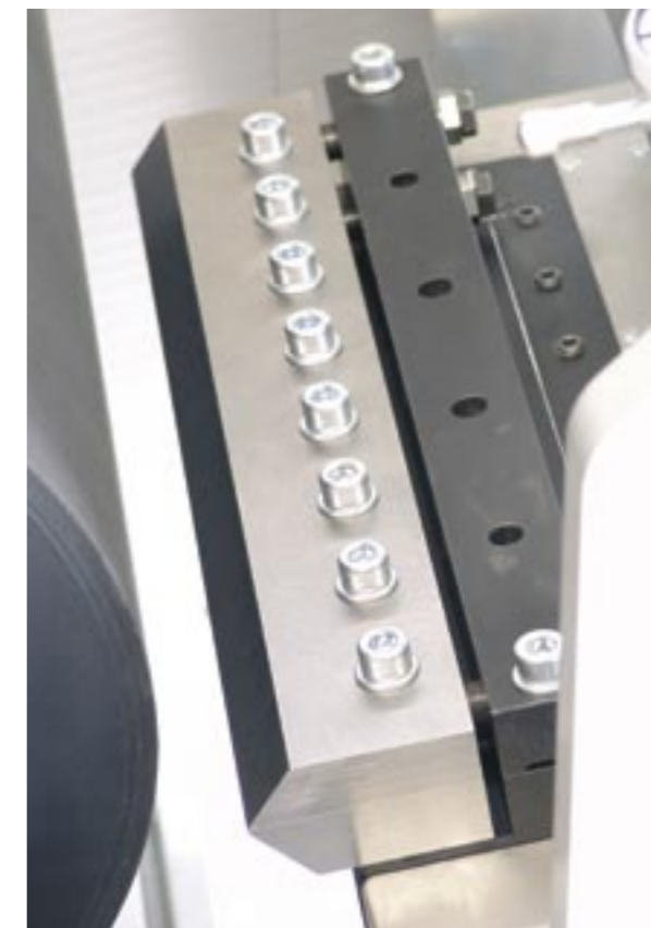
Auftragskopf mit Breitschlitzdüse für eine Labormaschine. Die zweiteilige Konstruktion gewährleistet eine schnelle Veränderung der Beschichtungsbreite mittels Einlegeblechen.
