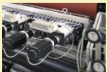
Einstellschlitten zur manuellen oder motorischen Ver- fahrung in y- und z-Achse, Einstellgenauigkeit 1/100mm
