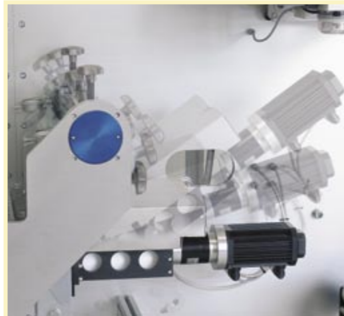
Dieser Auftragskopf mit Breitschlitzdüse und zusätzlicher Klebstoffpumpe ist für Einstellungs- zwecke komplett pneumatisch abschwengbar.
